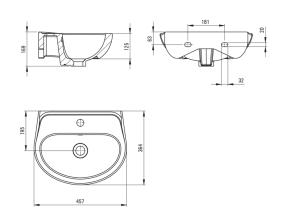
Tolerancja wymiarów  $\pm 5\%$  dla wartości do 200 mm i  $\pm 3\%$  dla wartości powyżej 200 mm All dimensions in mm tolerance  $\pm 5\%$  for below 200 mm and  $\pm 3\%$  for above 200 mm
