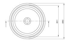
Tolerancja wymiarów  $\pm 5\%$  dla wartości do 200 mm i  $\pm 3\%$  dla wartości powyżej 200 mm All dimensions in mm tolerance  $\pm 5\%$  for below 200 mm and  $\pm 3\%$  for above 200 mm
