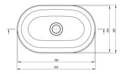
Tolerancja wymiarów ±5% dla wartości do 200 mm i ±3% dla wartości powyżej 200 mm All dimensions in mm tolerance ±5% for below 200 mm and ±3% for above 200 mm
